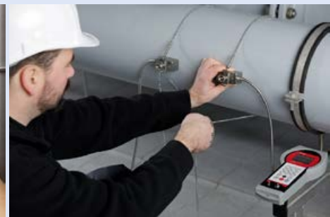
Die Einfachheit der Clamp-On Technologie: Ankleben und Messen
